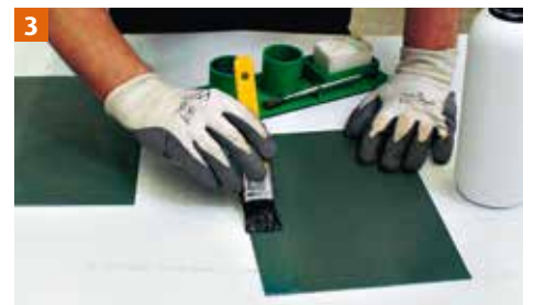
3 Behandeling van het gepigmenteerde oppervlak met een afbijtmiddel, laat het enkele seconden inwerken.
