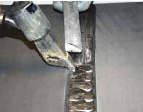
Aanbrengen van een toevoegmetaal
