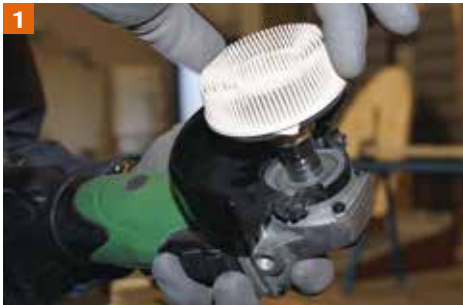
1 Breng de witte 3M™ Roloc™ - Bristle Disc aan op de slijpschijf.
