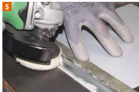
5 Verwijderen van de beschermlaag met 3M™ Roloc™ - Bristle Disc.
