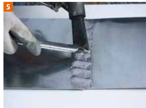
5 Realisatie van een geribde versterkte soldering op de gladde soldering.
