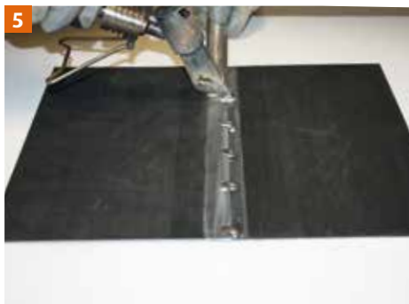
5 Puntsoldering van de te assembleren delen.
