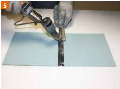
5 Puntsoldering van de te verbinden delen.
